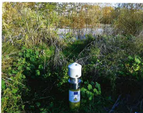
Photo 1. Piézomètre équipé d'un module de télétransmission. Source : Cliché des auteurs.
